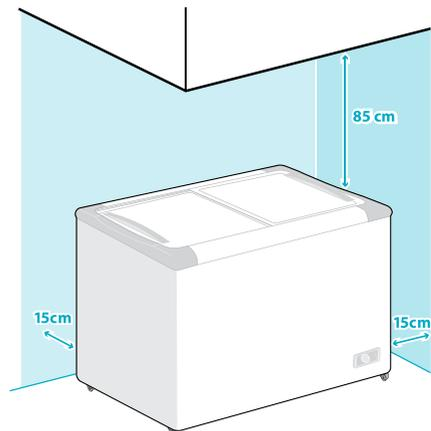
Instale o produto afastado de fontes de calor e livre da ação dos raios solares. Para garantir a circulação de ar, instale o produto respeitando as distâncias mínimas:
